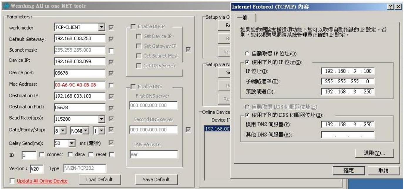
2. 測試通訊，PC 端執行“TCP Server”軟體並設定對應的 Port 號，發送 AT 指令 AT+0001-ReadVer 測試通訊是否正確：
