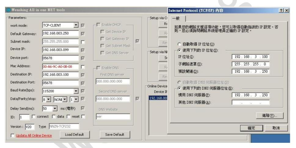
10. 測試通訊, PC 端執行"TCP Server"軟體並設定對應的 Port 號,發送 AT 指令測試通訊是否正確:
