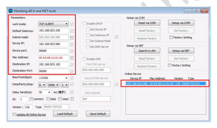
5. 修改更新主機的工作模式、IP 位置、Device port,並按"Setup via NET"鍵進行修改:
