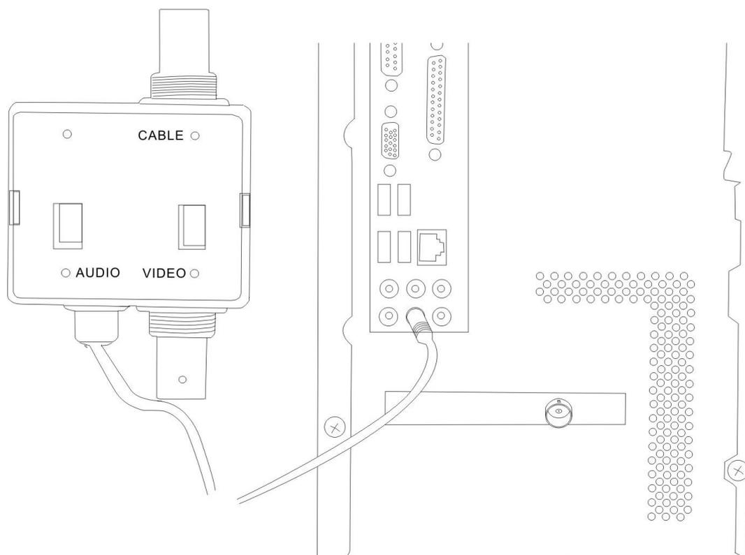
分別為發射端和接收端的兩個 **Audio Cable** 接上 **USB** 電源
