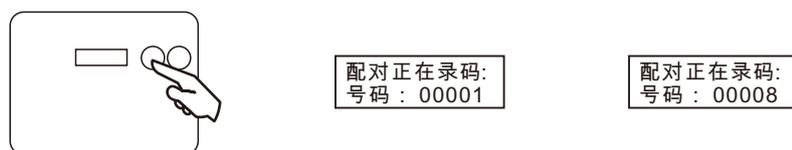
如需将豆子的号码归零重1开始，在录码状态下按住显示器的B键5秒再松开，然后一直按住显示器的A键不松手，将豆子移到主机读取，待显示器显示豆子号码变00001后才可以松开按键，此时号码归零操作完成，之前的豆子都要全部一粒一粒全部重录一次（一直按住显示器的A键不松手，将豆子移到主机读取，待显示器显示豆子号码变更后才可以松开按键），完成后按住显示器B键3秒再松开关机保存。
